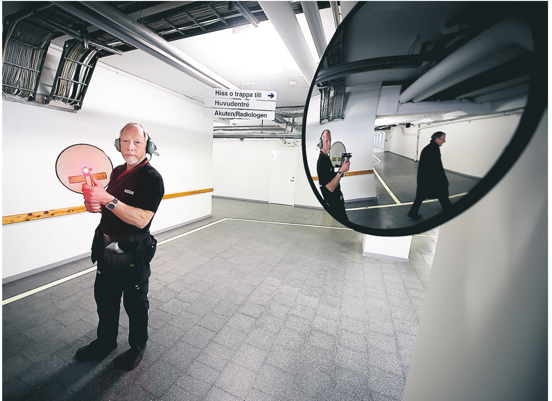
Gerhard Svensson letar med hjälp av ultraljudsutrustning efter gasläckor längs rören på Nyköpings lasarett. Lustgasanvändningen har ökat oförklarligt på lasarettet det senaste året. FOTO: DAVID LUNDGREN
